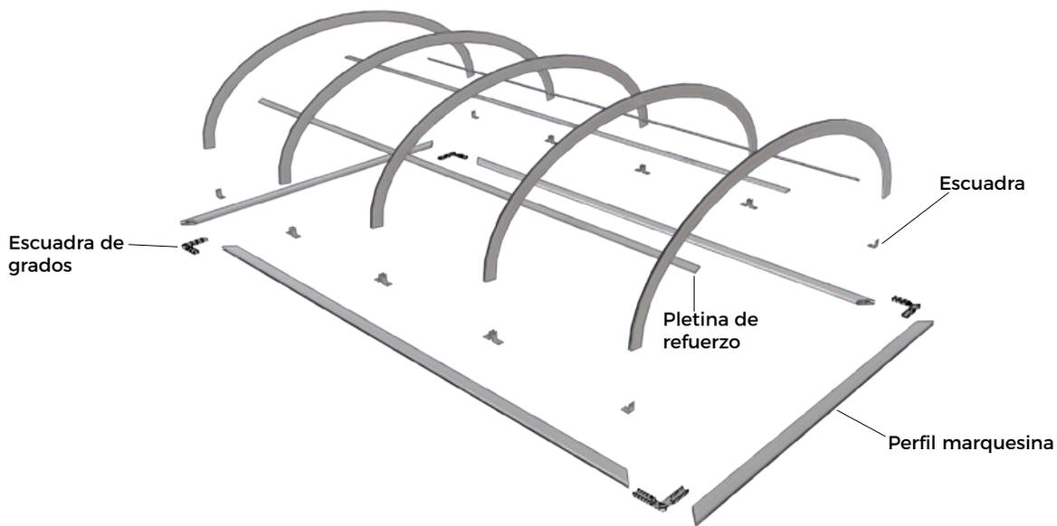
Modelo de túnel estándar. La construcción de la estructura puede variar.
